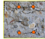
鉄筋周辺の水平ひび割れの発見
